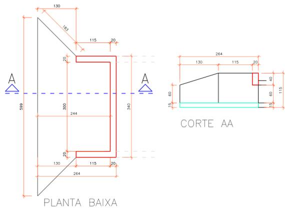
DETALHE 02-DISSIPADOR FINAL DA GALERIA DA BARRAGEM
